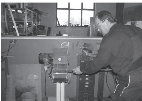
Hier bekommt ein Stab eine scharfe Spitze, dass die Funken fliegen
